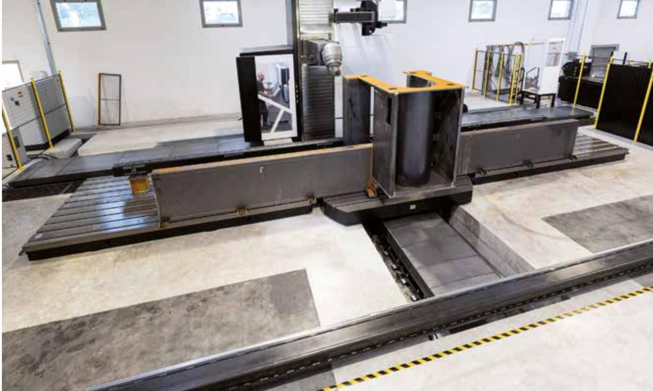
**La tavola roto-traslante di 3.500 x 2.500 mm permette la rotazione di 180° di particolari importanti e assicura la loro completa lavorazione su 5 facce.**
