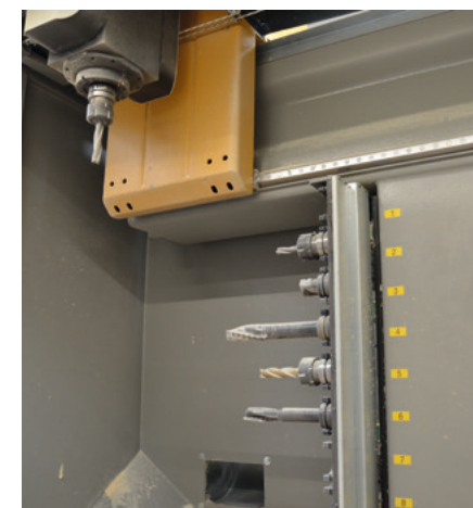
Das Fräsaggregat mit automatischem Werkzeugwechsler erledigt etliche Bearbeitungsschritte, sämtliche Zuschnitte erfolgen durch die mit einem 1200 mm-Durchmesser-Sägeblatt bestückten Spindel.
