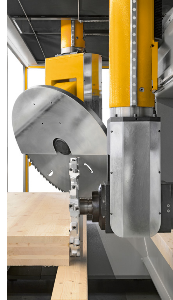
Das Fräsaggregat mit automatischem Werkzeugwechsler erledigt etliche Bearbeitungsschritte, sämtliche Zuschnitte erfolgen durch die mit einem 1200 mm-Durchmesser-Sägeblatt bestückten Spindel.
