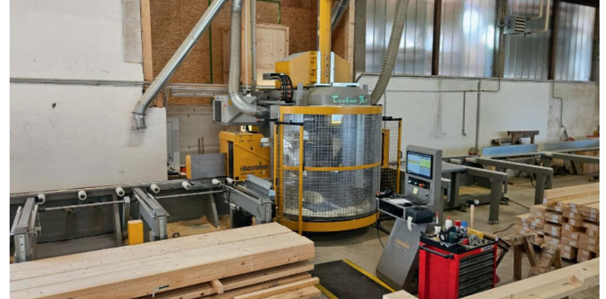
**Gelungene Adaptierung:** Aufgrund des Platzmangels in der Halle fiel die Entscheidung auf eine Essetre TechnoFast. Diese spart in der Breite Platz, da die Maschine die Holzstäbe stehend verarbeitet. Zudem ist sie um viele Features erweiterbar
